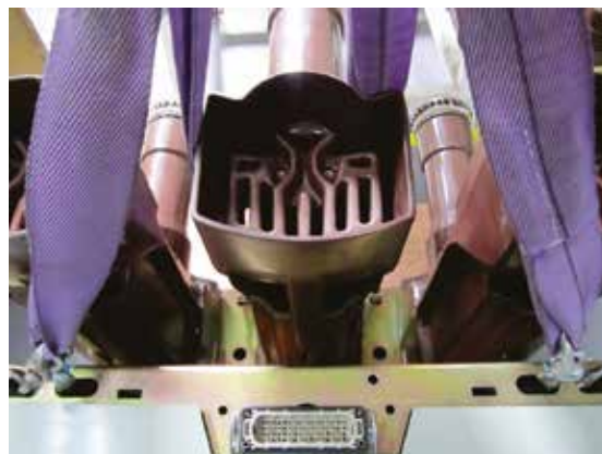
图. 5.2 3AE-SION EP®真空断路器的吊装
